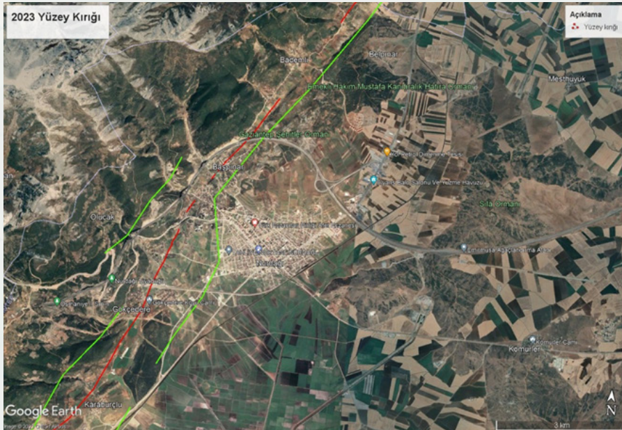
Şekil 1.2. a) Uydu görüntüsünden yapılan aktif fay izi ve yüzey kırıkları dağılımı (üstteki) (Tarı-Yaltırak) b) MTA aktif fay haritası (yeşil) ile yüzey kırığının farklılığı (alttaki) (kırmızı çizgiler).
