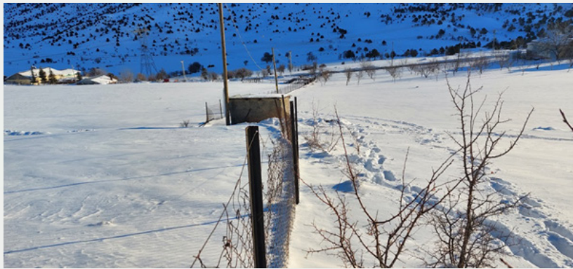
Şekil 1.8. Çardak Fayı üzerinde Nurhak batısında tel örgülerde oluşan ötelenme (4,2 m) (Foto: Dr. Taylan Sançar, Munzur Üniversitesi).
