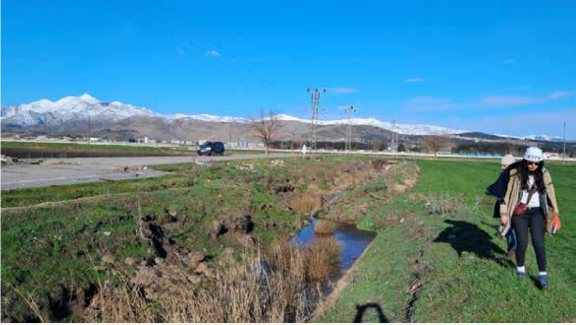
Şekil 1.15. Türkoğlu doğusunda asfalt yolda ve su kanalında 330 \pm 10 cm sol yanal ötelenme (Enlem: 37^{\circ} 22' 14,148'' N; Boylam: 36^{\circ} 52' 10,458'' E; Yükseklik: 512 m)
