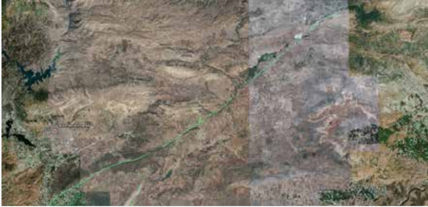
Şekil 1.8. Gölbaşı- Türkoğlu arası üzerinde Mw 7.8 büyüklüğündeki depremin yüzey kırığının yüksek çözünürlüklü uydu görüntüsü ile yapılmış haritası (hassasiyet 30 cm)
