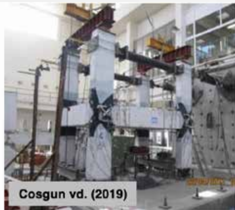
Şekil 4.6. İTÜ'de yapılan lifli polimer ile güçlendirme çalışmalarından örnekler (Bedirhanoğlu 2009, Ghate et al. 2015, Cosgun vd. 2019, Seyhan vd. 2023)
