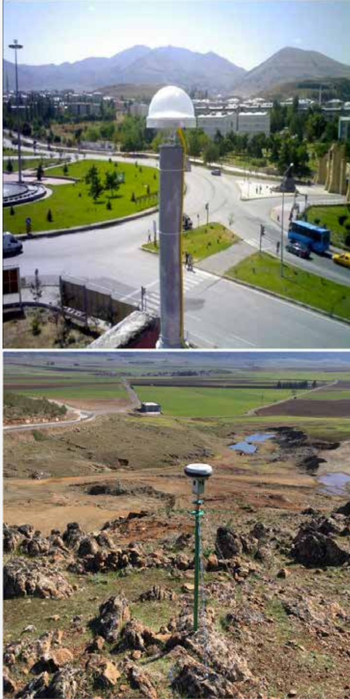
Şekil 1: ERZR-Erzurum TUSAGA-Aktif istasyonu (üstte) ve PT38 kampanya tipi GNSS gözlem noktası (altta) görünüm.
