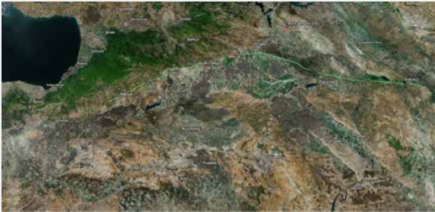
Şekil 1.9. Türkoğlu-Hatay arası ve Pazarcık segmentinin yüzey kırığının yüksek çözünürlüklü uydu görüntüsü ile yapılmış haritası (hassasiyet 30 cm)
