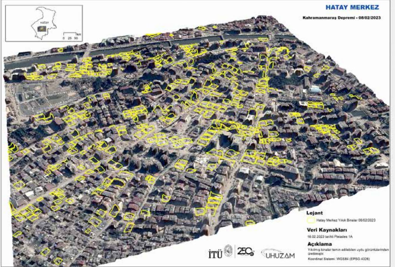
Şekil 3.5. 16.02.2023 tarihli Pleiades 1A stereo görüntüden üretilen sayısal yükseklik modeli ve Pleiades 1a Doğal Renkli Görüntü
