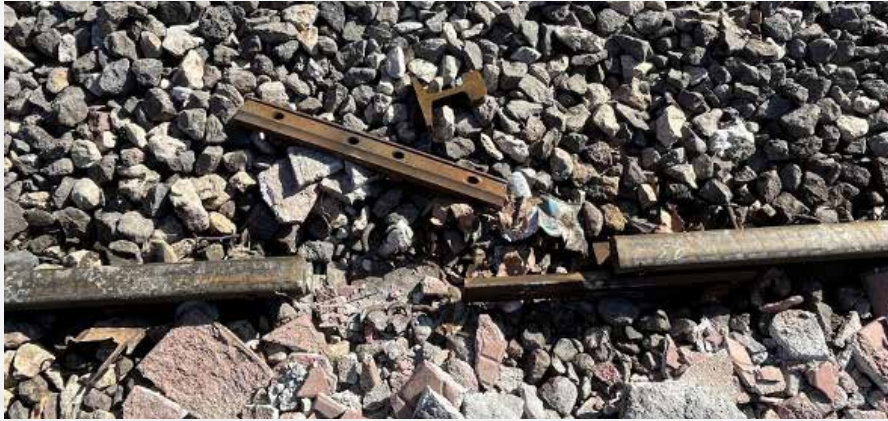
Resim 22. Kopma hasarı ile ek yerinden ayrılan raylar
